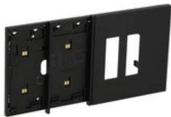
Frame elettrificato con mostrina doppia presa Italia, per l'installazione di 2 comandi digitali e di 2 prese (articoli compatibili: KG4033, KG4002, KG4113, KG4180). Installazione in scatola da 4 moduli con supporto K4704. Colore nero.
